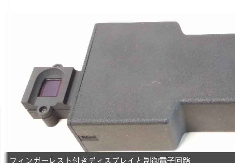
フィンガーレスト付きディスプレイと制御電子回路
