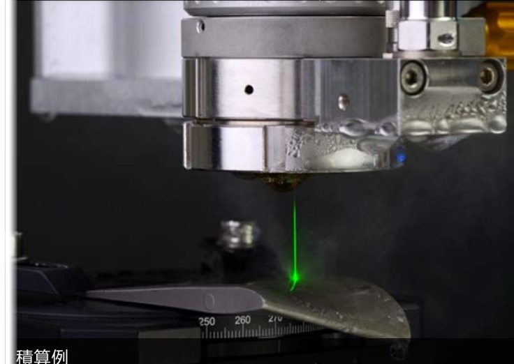
OCTを用いたワークのトポグラフィー計測
