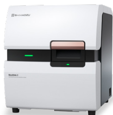
マイクロチップ電気泳動システム MultiNA II MCE-301
