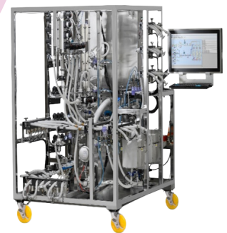
バッファー調整機能統合型連続クロマトグラフィー QuantaSep Fusion DSP
